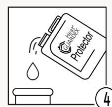
Шаг 4 - Залить защитный ингибитор в систему
